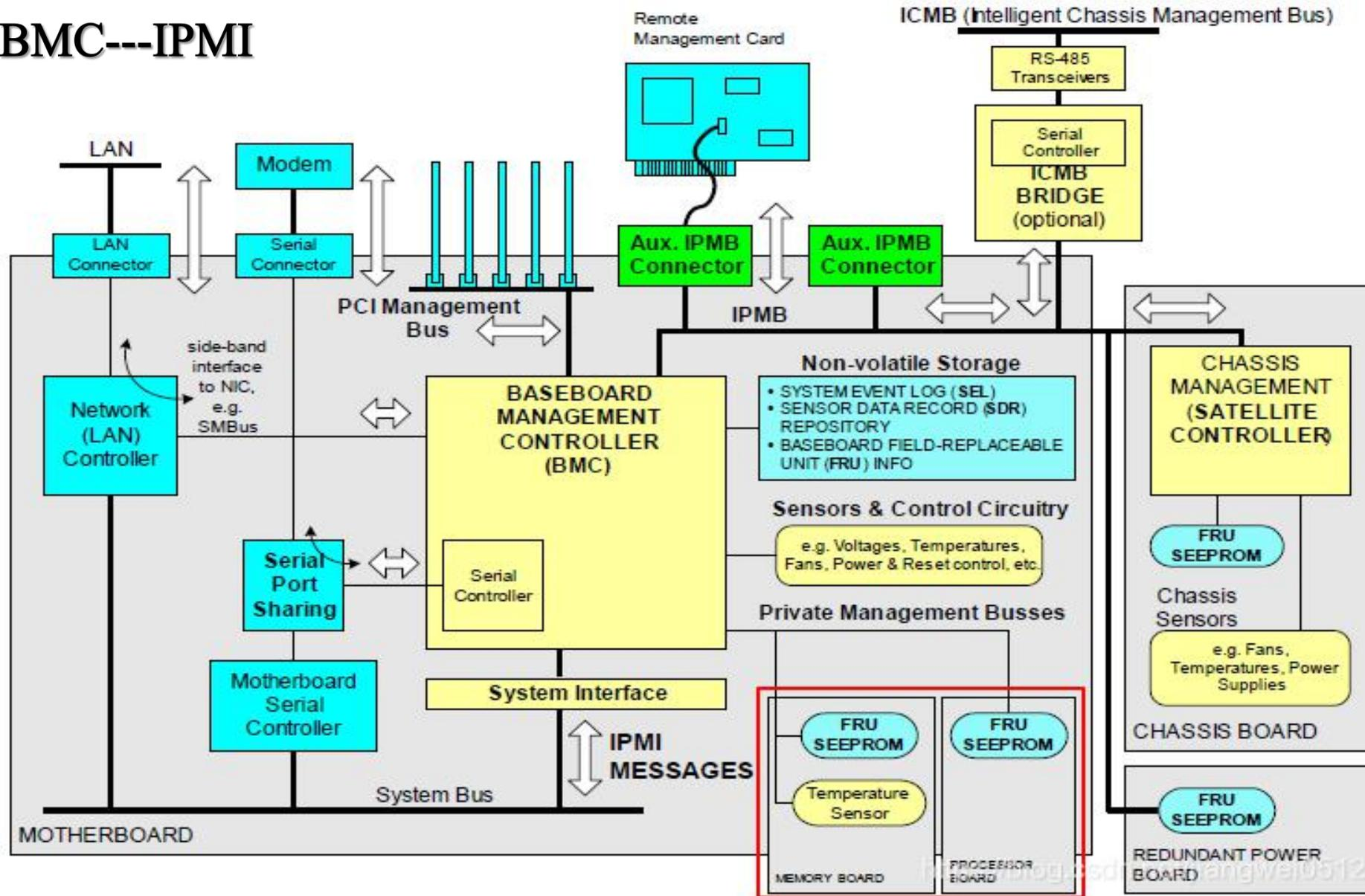
左图显示了IPMI系统中的各组成元素，IPMI系统的核心是一块BMC(Baseboard Management Controller)的控制板，BMC实现了IPMI协议中的大部分功能。而且BMC并不依赖服务器的CPU、BIOS或者操作系统来工作，是一个单独在系统内运行的无代理管理子系统。BMC能够提供自主监控、事件记录、日志提取，并作为网关在系统管理软件和IPMB(Intelligent Platform Management Bus)、ICMB(Intelligent Chassis Management Bus)之间提供服务。
